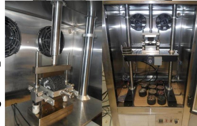
Figura 1 – Ensaio de Fadiga por Compressão Diametral
