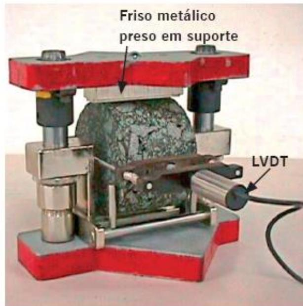
(b) Corpo-de-prova com um único LVDT
